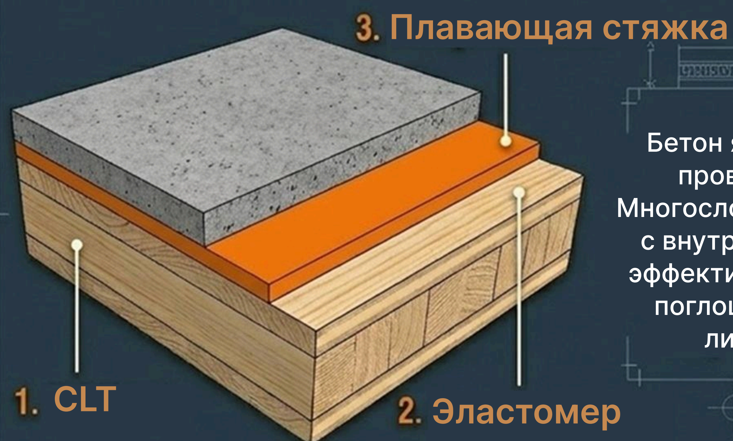
Технический разрез межэтажной панели
